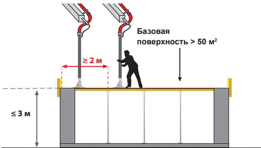
Внутри 2 м границ безопасности до неогражденного края бетонные работы выполняются без лица, работающего с концевым шлангом.
