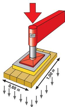
Давление на грунт может при 0,6 м<sup>2</sup> составлять до 750 кН/м<sup>2</sup>.
