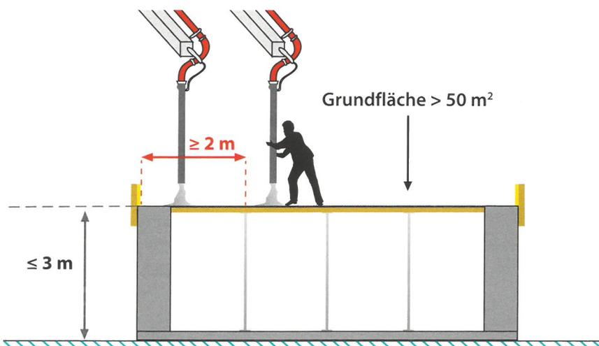
Die 2 m Sicherheitsabstand bis zur Absturzkante werden ohne Endschlauchführer betoniert.
