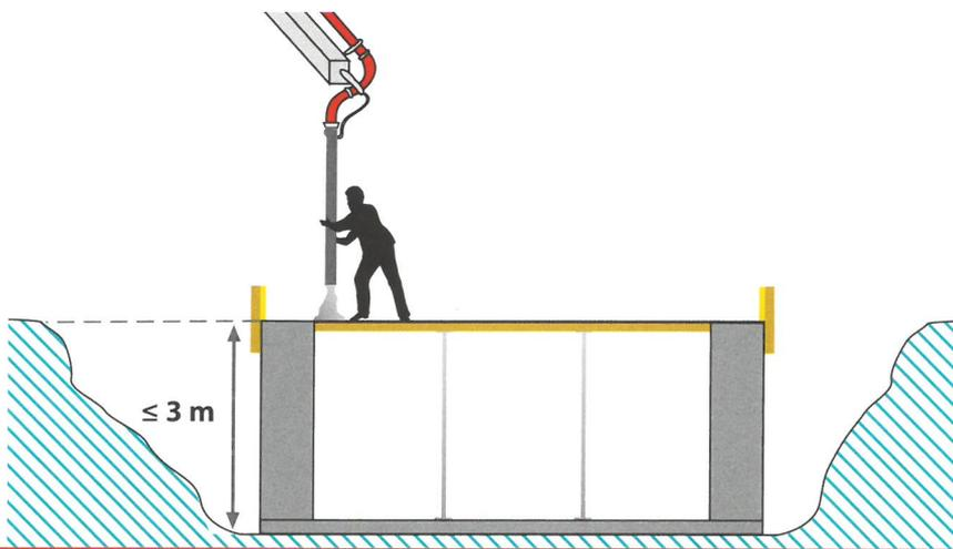
Bei einer EG-Geschossdecke und einer Absturzhöhe  $\leq 3\text{ m}$  kann auf eine Absturzsicherung verzichtet werden.
